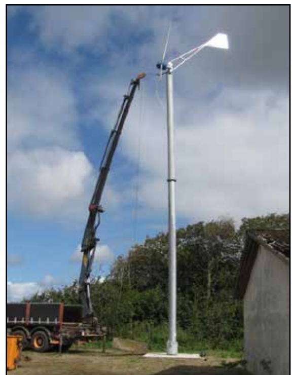
Trækprøvning af tårn med kendt vægt.
