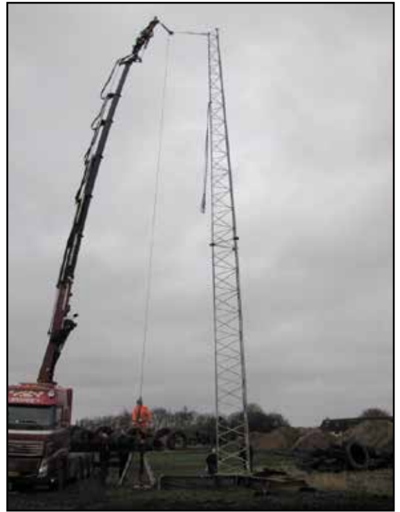
Trækprøvning af tårn med vejecelle.
