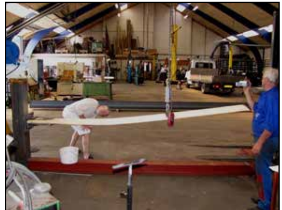
Trækprøvning af vinge i værksted.
