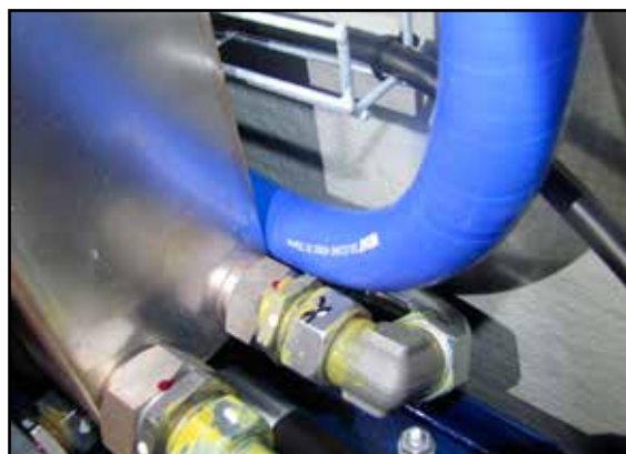
Slange der slides på skarpe kanter.
