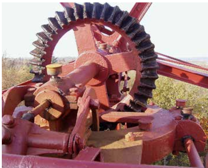
Klapsejleren på Hjerl Hede har den eneste bevarede af de ca. 400 ”vindmotorsæt” fra Holstebro Jernstøberi. ”Vindmotorsæt Nr. 23” blev introduceret i 1915 som det mindste af ”sættene” til 5-vingede møller – og der blev frem til 1920 solgt 58 af dem. (Foto: Benny Christensen 2003 og illustration fra prisliste i Holstebro Lokalhistoriske Arkiv)
